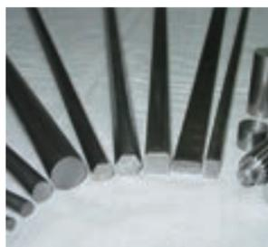
磨棒鋼は、ダイスを通じて引抜加工した精密な棒鋼二次製品。シャフトを始めボルト、ナット、ネジ等の機械部品に加工され、自動車、建機、OA機器などに組み込まれています。磨棒鋼の素材となる炭素鋼、合金鋼、ステンレス鋼等を各地の磨棒鋼メーカーに販売しています。
