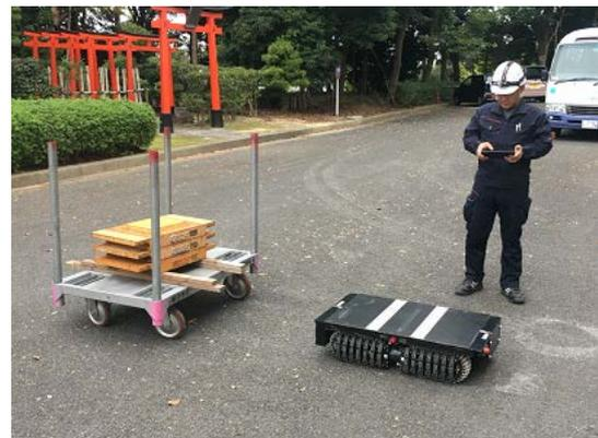
【仕様】 サイズ：幅 54cm、長さ 92cm、高さ 24.6cm 本体重量：120kg 走行速度：3km/h
